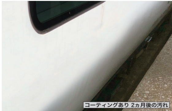
▲／▼コーティングの有無による2ヵ月後の汚れの比較。上がコーティング未施工、下がコーティング施工をした部位で、雨だれの汚れの付き方に違いが確認できる。
