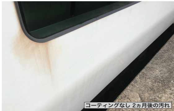
▲／▼コーティングの有無による2ヵ月後の汚れの比較。上がコーティング未施工、下がコーティング施工をした部位で、雨だれの汚れの付き方に違いが確認できる。
