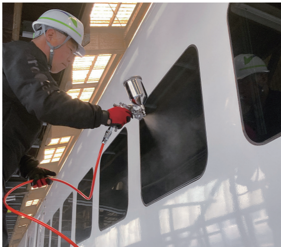
▲スプレーを使ってコーティング作業をしている様子。
