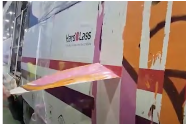
スクレーパーによるラッカー塗膜剥離
